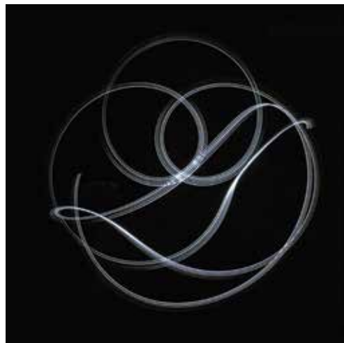
Kaligrafia przestrzenna Grzegorza Banaszkiewicza. Takie kształty zarysowuje w ciągu kilku sekund końcówka drugiego wahadła wyposażona w kilka białych diod, fotografowana w ciemnym pomieszczeniu.
